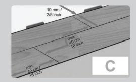
ث-تـایل ها را یکی پس از دیـگری با جایگذاری لبه نر در لبه مـادگی و با زاویه ۳۰ -۲۰ درجهو فشار اندک نصب کنید (شکل ۴ ) .
